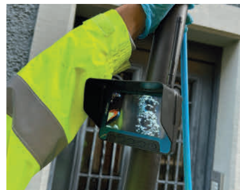
Modulare Teleskopleitung für die Dachrinnenreinigung.
